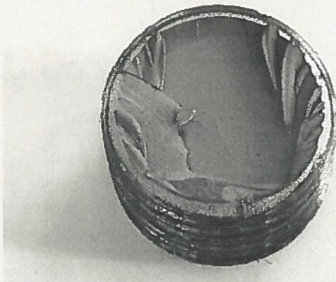
Bild 4: Dauerbruchfläche 7 n. i. O.
