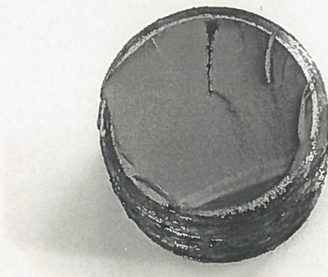
*Bruchbilder der n. i. O. Versuche 2, 3, 6, 7, 11, 13 u. 14 von links nach rechts und oben nach unten.*
