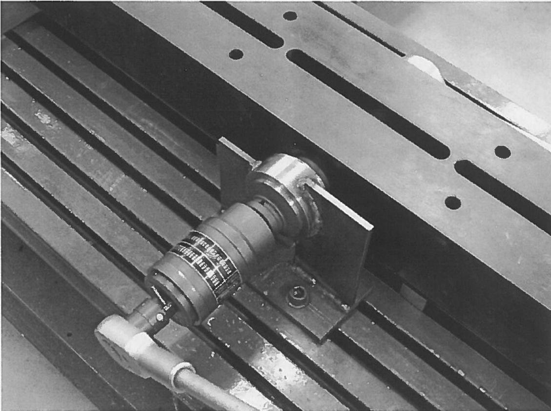
*Bild 12: Vorspannen mit Untersetzungsgetriebe*
