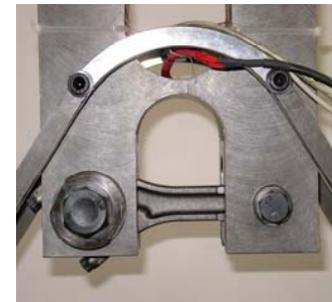
Bild 1: Resonanzpleuelprüfmaschine
